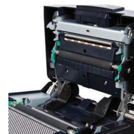
La DB-EA4D incorpora fácil acceso al recorrido del papel, mantenimiento sin herramientas y 2 cabezales para imprimir simultáneamente en las caras delantera y trasera del papel térmico.
